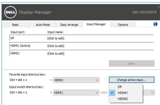
**NOTA:** O DDM se comunica com seu monitor mesmo quando ele está exibindo vídeo de outro computador. Você pode instalar o DDM no computador que você usa frequentemente e controlar a mudança de entrada através dele. Você também pode instalar o DDM em outros computadores conectados ao monitor.
